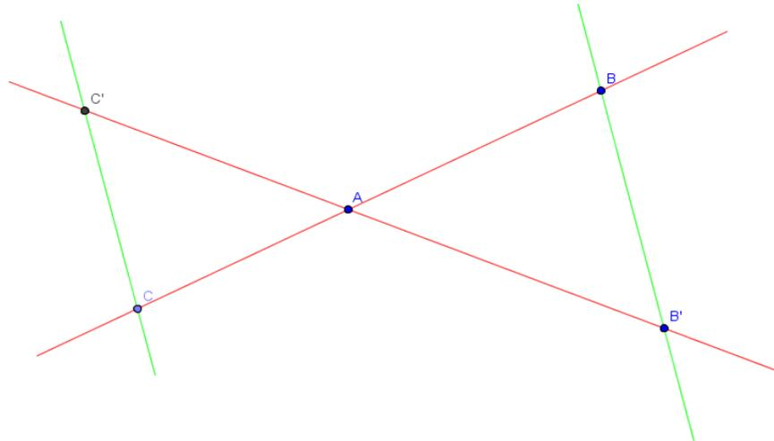
Les droites  $(BC)$  et  $(B'C')$  sont sécantes en A et  $(BB') \parallel (CC')$  alors  $\frac{AC}{AB} = \frac{AC'}{AB'} = \frac{CC'}{BB'}$
