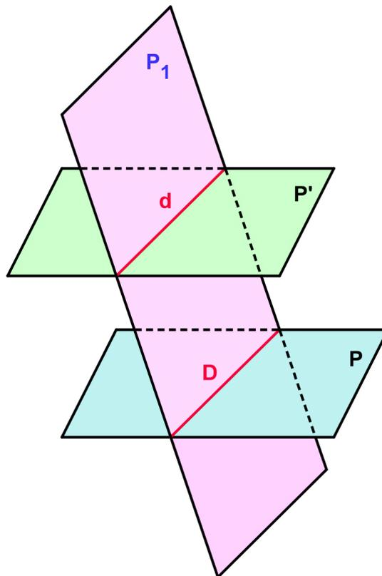
Si une droite  $d$  est parallèle à une droite  $D$  contenue dans le plan  $\mathcal{P}$  alors  $d$  est parallèle à  $\mathcal{P}$ .
