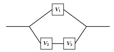
Le circuit est en état de marche si  $V_1$  est en état de marche ou si  $V_1$  et  $V_2$  le sont simultanément.
