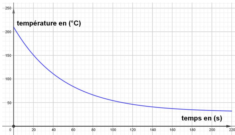
1. L'objet peut-être démoulé lorsque la température devient inférieure à  $50^{\circ}\text{C}$ .
